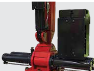
8 sekcijski elektro- proporcionalni hidraulični ventil omogućava precizno upravljanje sa upravljačkom konzolom.
